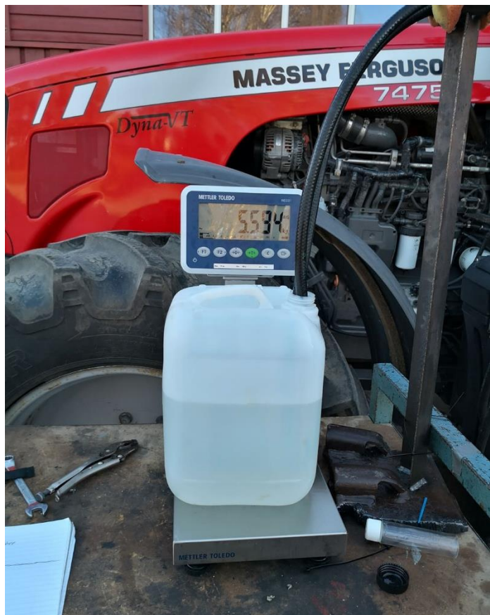
Figur 3 oppsett av dieseltilførsel og vekt. Foto: Øivind Karlsen
