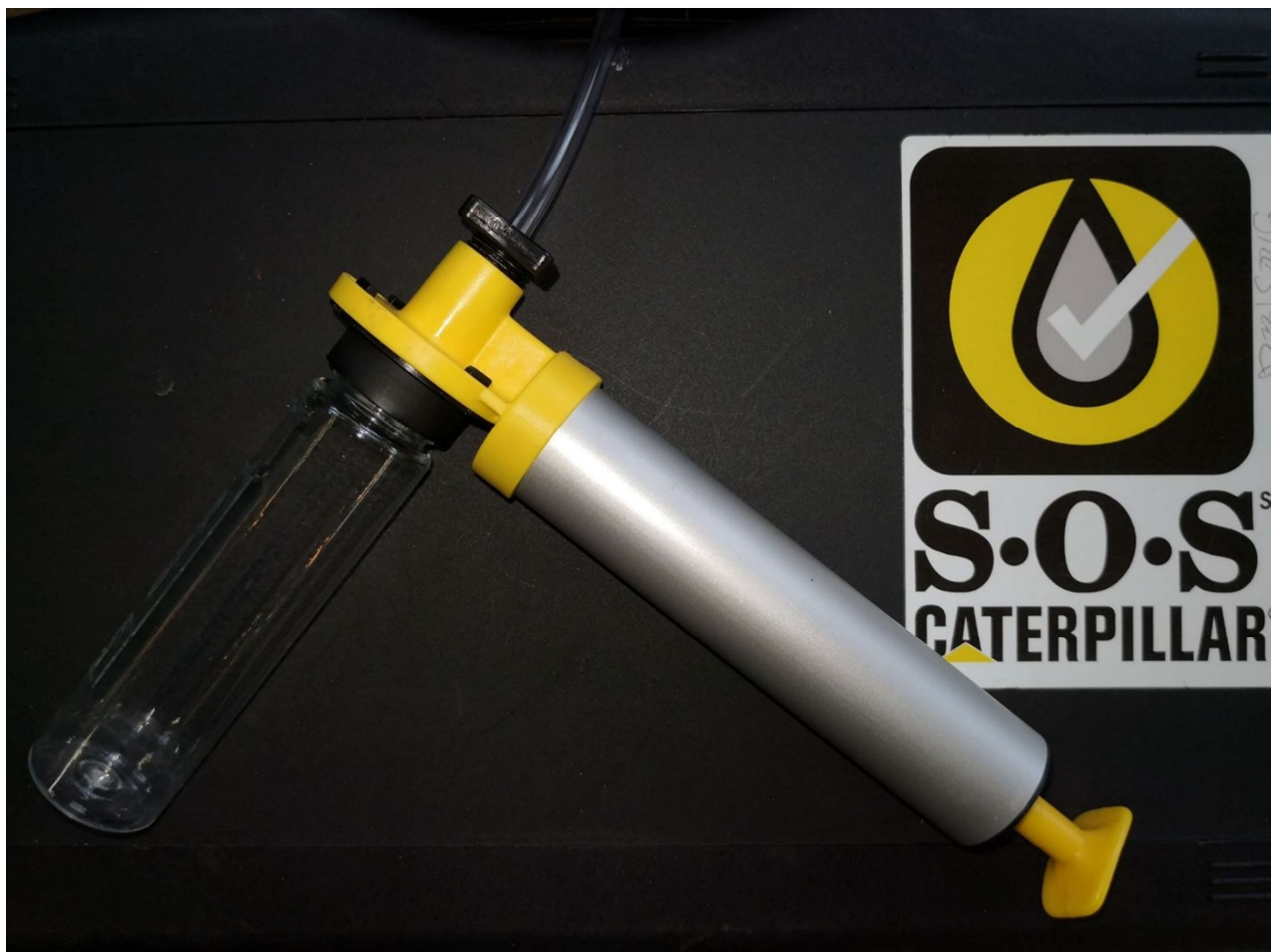
Bilde 4. Viser prøvetakingsutstyret for oljeanalyser (Foto: Forfatteren).
