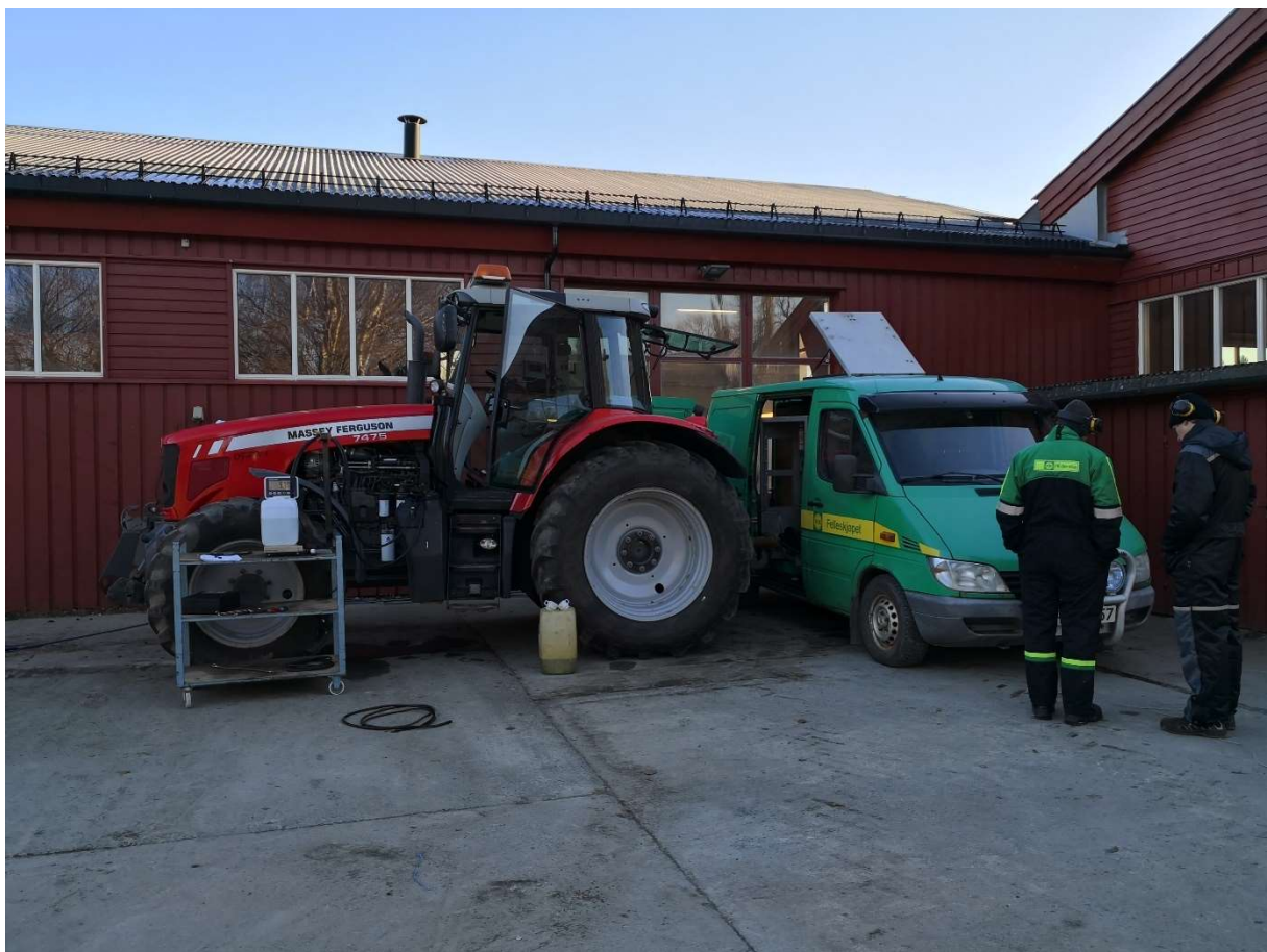
Bilde 3. Viser bremsing av Massey Ferguson 7475. Dynamometeret er fastmontert i bilen. (Foto: Forfatteren)
